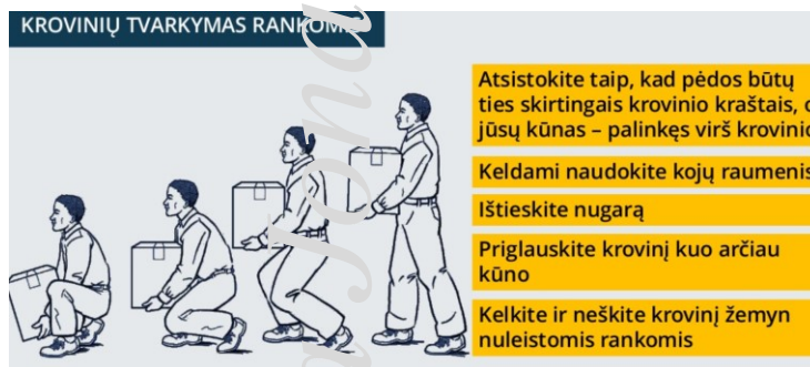
7 pav. Saugus krovinio suėmimas ir pakėlimas (3).
